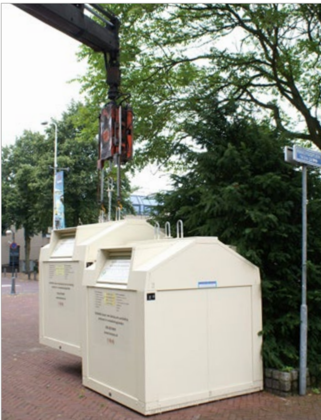
Entleerung durch Öffnen der Bodenklappen mittels LKW-Kran
