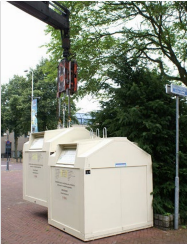
Lediging door openen van de bodemkleppen met de vrachtwagen kraan
